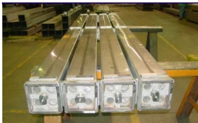
HI-STORM受損燃料罐
