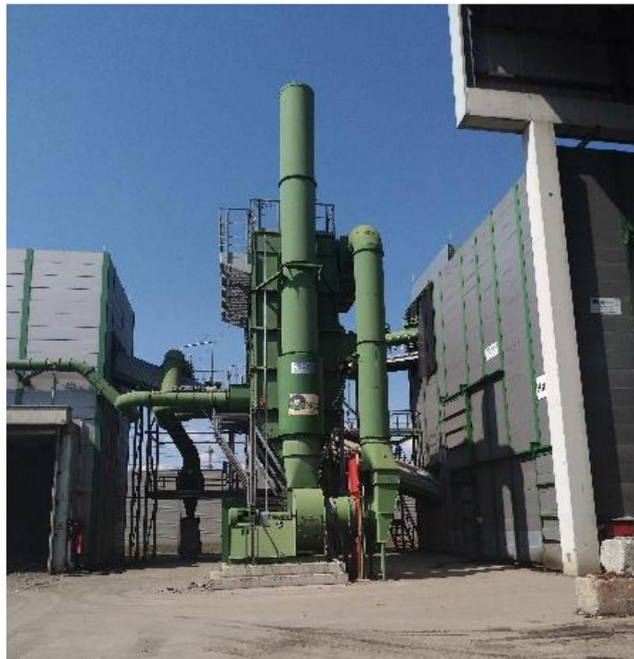
圖 6 整機破碎分選處理系統污染防制設備
