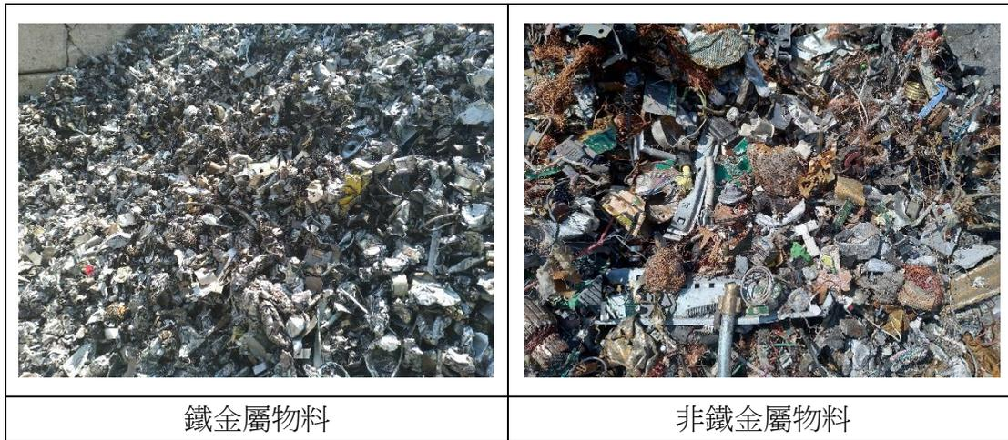
圖 8 整機破碎分選處理系統分選出的物料
