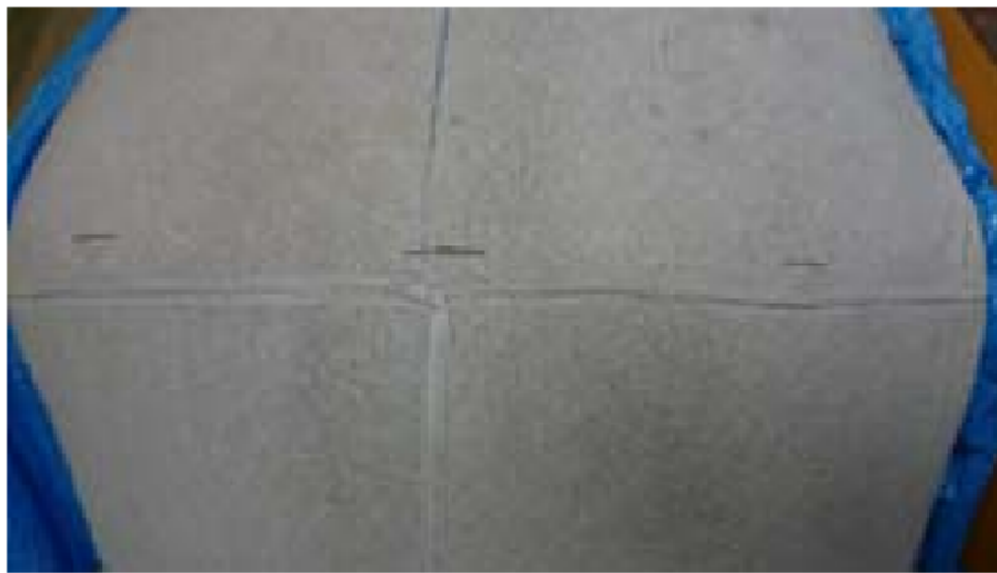
圖3.15 脊頂彎曲試驗在77度時沙腸袋損壞區開裂情況
