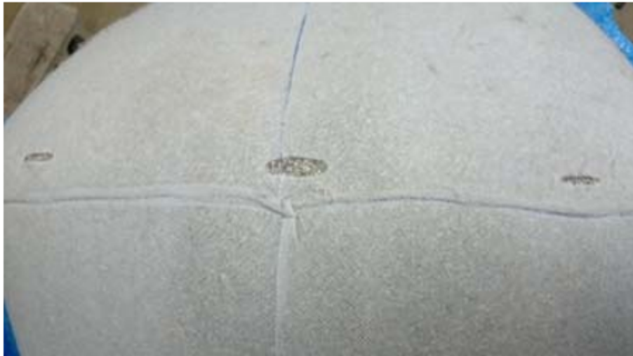
圖3.16 脊頂彎曲試驗在93度時沙腸袋損壞區開裂情況
