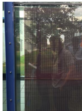
圖 15 運用熱能儲存窗簾將管內水加熱
