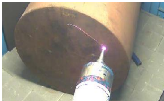
圖 6、儲存槽內牆切割
