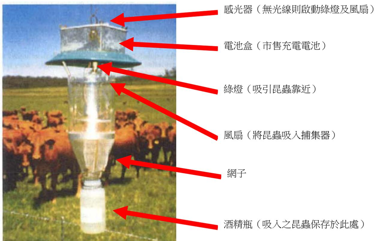
圖四：西澳大利亞州之蚊蠓捕集器，係向廠商訂製，各州型態略有不同但構造原理相同
