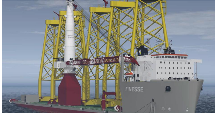
圖 1.3-3 參訪 Boskalis 模擬之船隻-安裝起重船(installation crane vessel)
