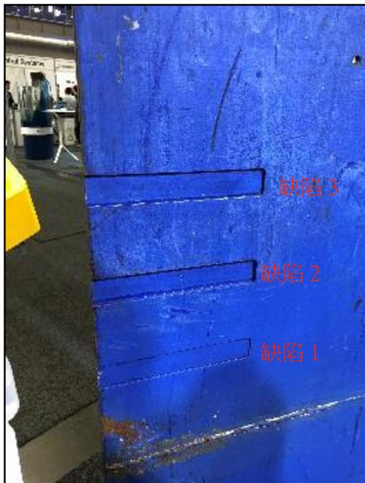
B-Scan 圖中顯示掃描路徑有三個缺陷，分別為缺陷 1、缺陷 2 及缺陷 3，缺陷 1 厚度約為 8mm、缺陷 2 約為 3mm、缺陷 3 約為 6mm，缺陷 2 為較嚴重之腐蝕。X 座標為量測厚度值、Y 座標為掃描路徑跟起始點距離，因此缺陷 2 大約距離起始點 450mm 而厚度約為 3mm，而正常板厚為 10mm。接著用 A-Scan 分析，gate 設定為 52%，而涵蓋 4 個回波訊號，利用 peak to peak 計算方式可將詳細厚度值 3.449mm 顯示出來（詳見右上方藍色顯示介面）。
