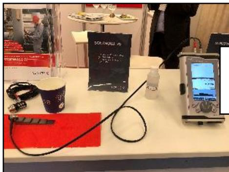
圖 24. SONOTEC 公司測厚儀
