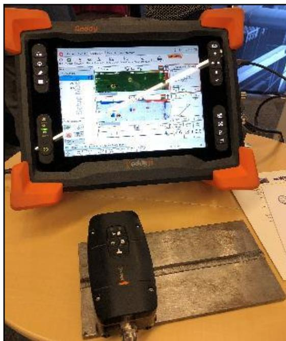
圖 10. eddyfi 渦電流銲道檢測
