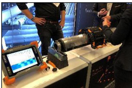
圖 7. eddyfi 公司脈衝式渦電流儀器
