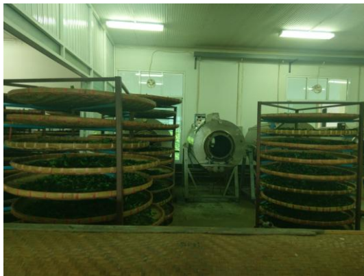
圖 31：安康農場茶廠內室內萎凋、浪菁機、炒菁機等製茶設備齊全。
