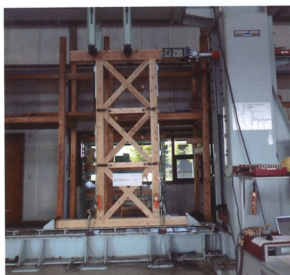
耐力壁の試験実施
