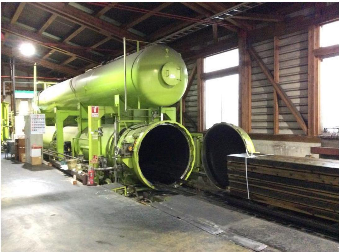
圖42. 切割加工完成之構件進行防腐防蟻處理
