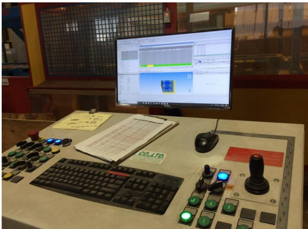
圖40. CAM 匯出加工資訊傳送至機器端切削加工
