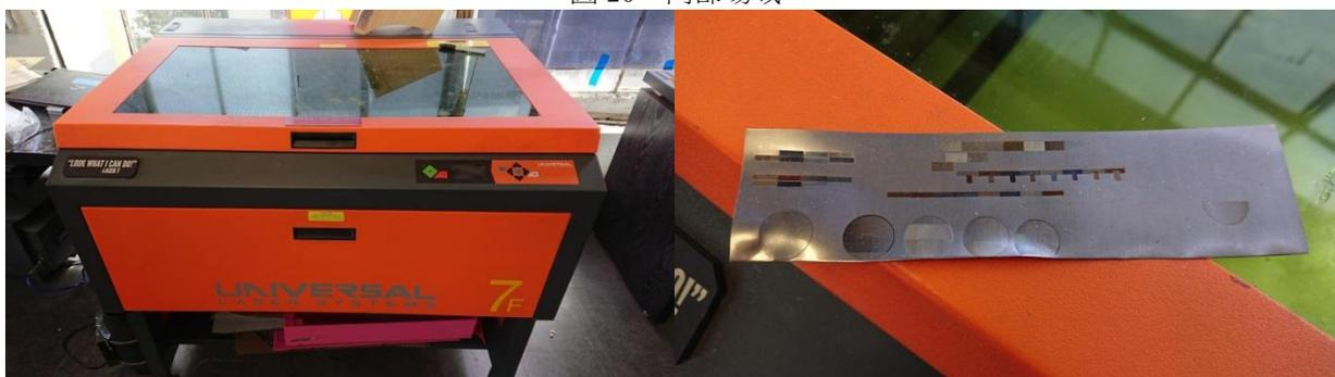
圖 21 內部設備\_彩色雷射雕刻機
