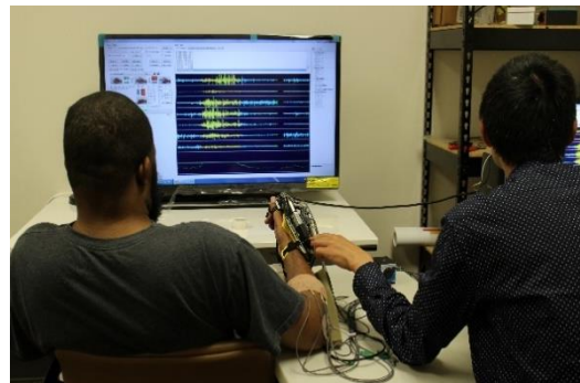
圖 31 機器人手指訓練配合肌電訊號
