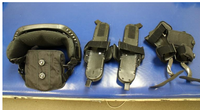
圖 25 Indego，試用外骨骼系統練習行走，Indego 可拆卸成四個部分，方便攜帶
