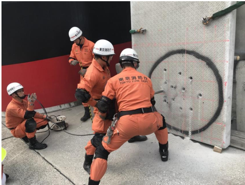
圖 17：東京消防廳示範破碎機破碎鋼筋混凝土
