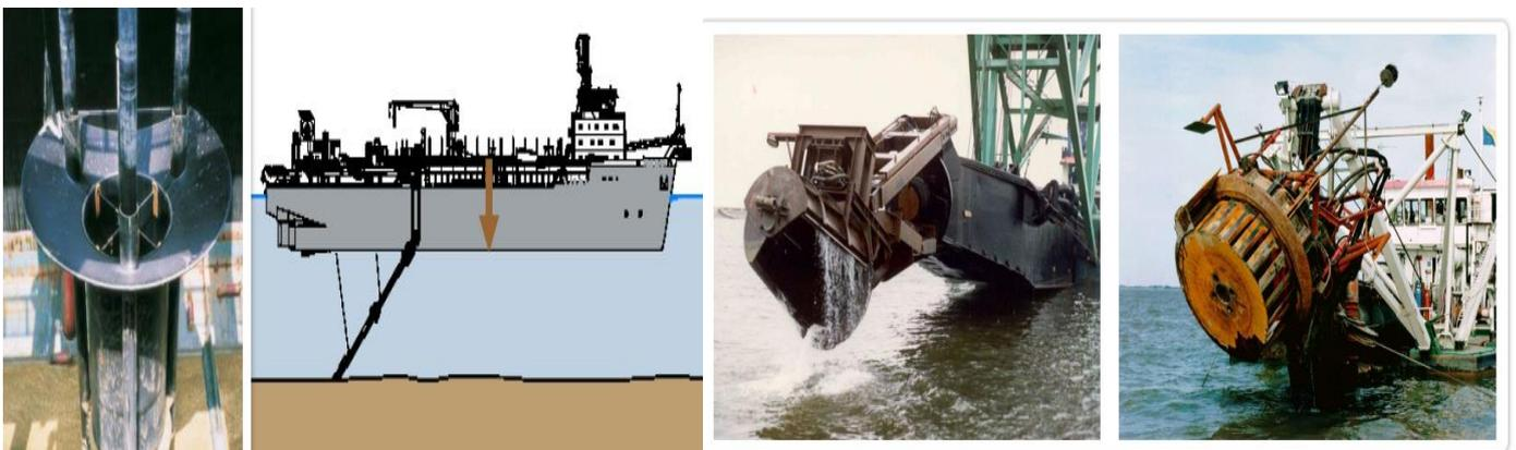
圖 1-4-6. 耙吸式及絞刀式浚挖船對於汙染逸散改善的作為<sup>81</sup>
