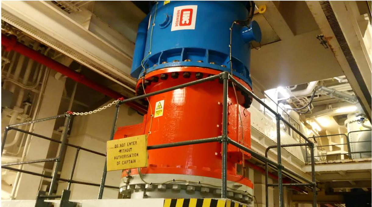
圖 1-3-16. 耙吸式挖泥船上監測輸砂速度及密度儀器
