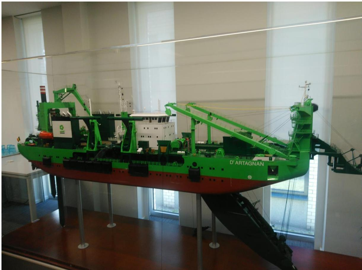
圖 1-3-11.浚挖環境及海事工程集團內絞刀式浚挖船模型
