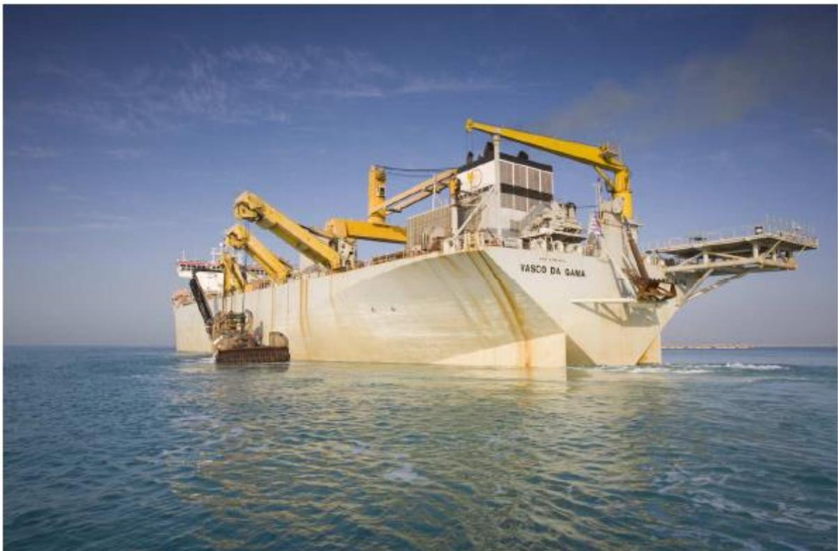
圖 1-3-7. 耙吸式挖泥船<sup>\*1</sup>
