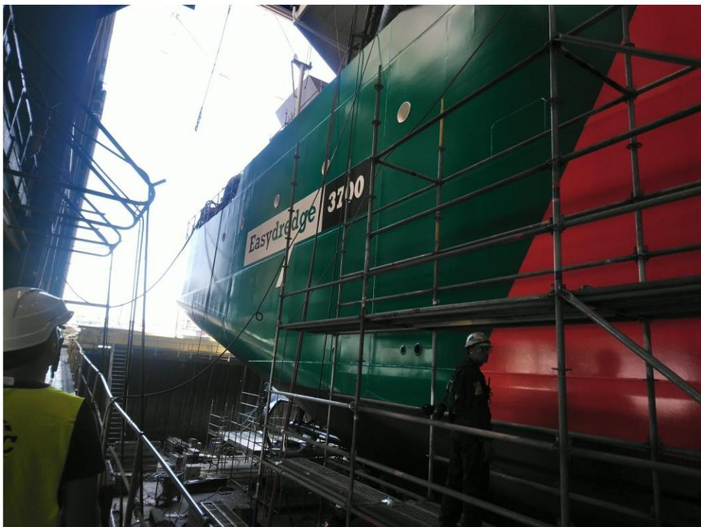
圖 1-3-21.組裝中的耙吸式挖泥船 Easydredge 3700
