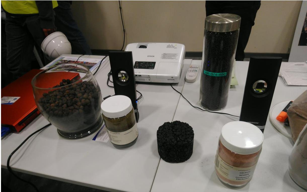
圖 1-2-15. 以脫水浚挖泥砂所開發之各種建材
