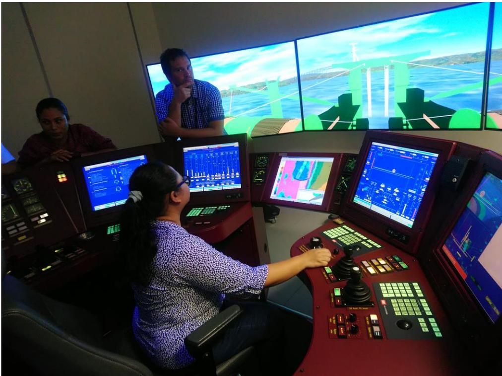
圖 1-3-13.由學員操作絞刀式浚挖船模擬系統（CSD）
