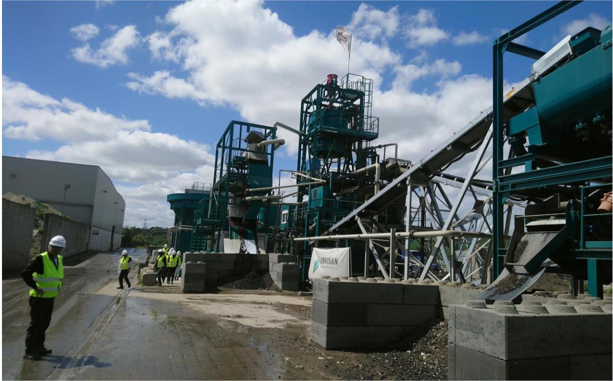
圖 1-3-5.汙染土壤回收及再處理中心（Hulsdonk）機械式過篩機
