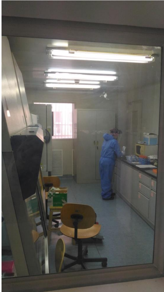
提取空間完全密閉，並為負壓環境，不讓細菌等微生物影響古生物 DNA 抽取。
