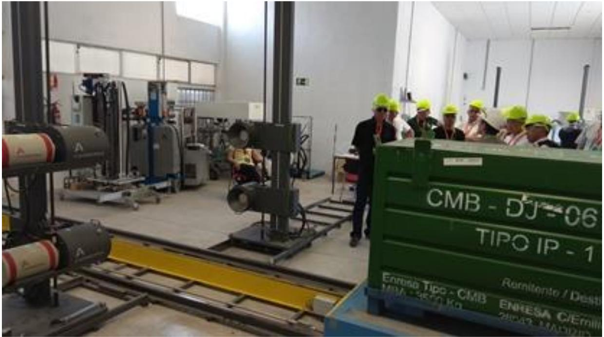
圖二十二、José Cabrera 核電廠解除管制量測室—廢棄物外釋度量設備
