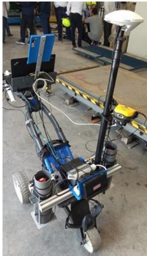
圖二十一、José Cabrera 核電廠解除管制量測室—土地輻射特性量測設備
