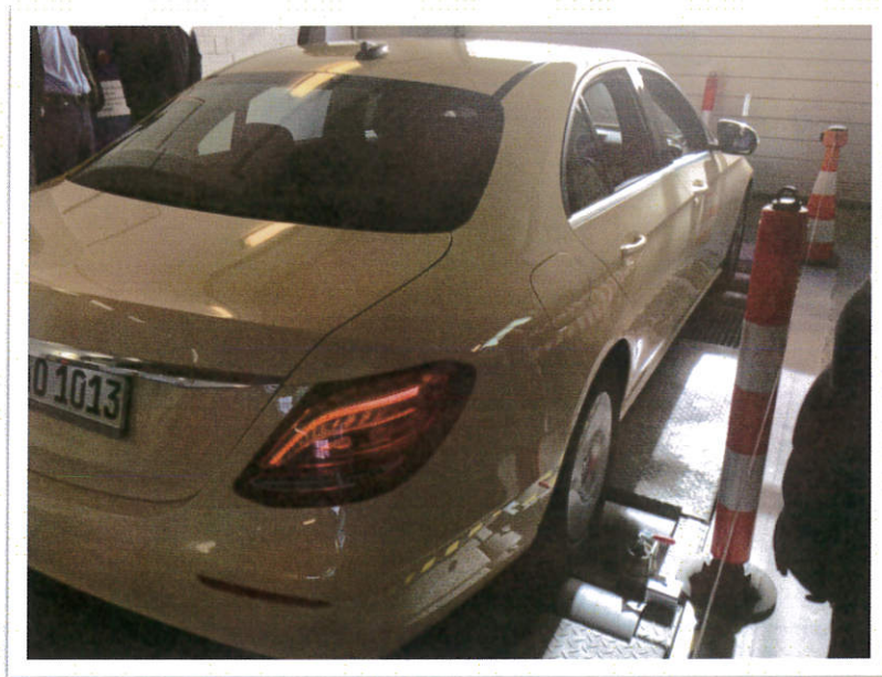
圖 10 漢堡檢定站計程車於輪行檢定設備辦理計費表檢定情形
