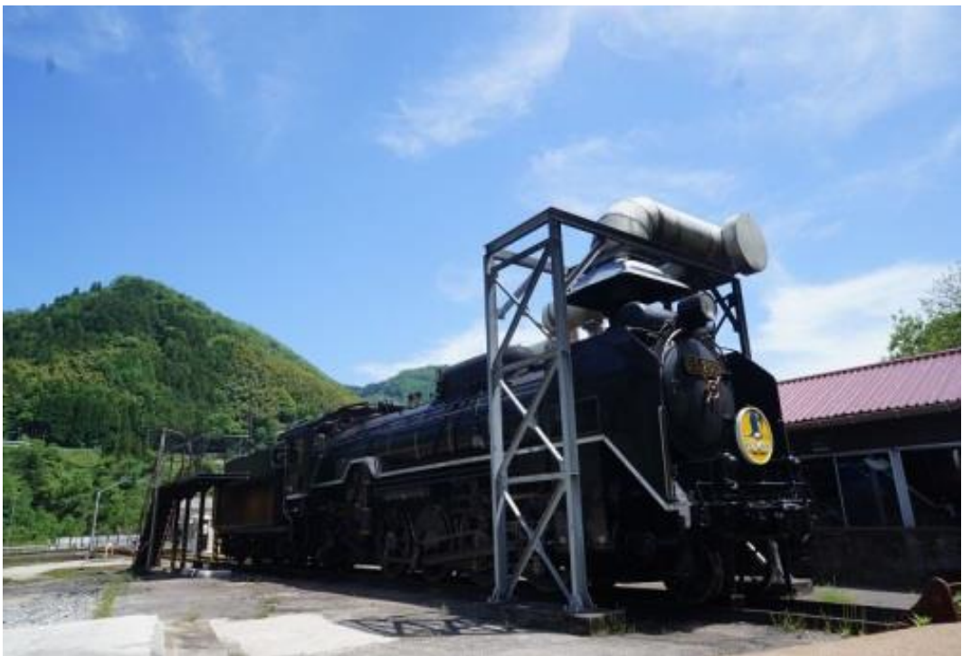
圖59 設置有煙霧集塵裝置 以符合日本大氣污染防治法規定
