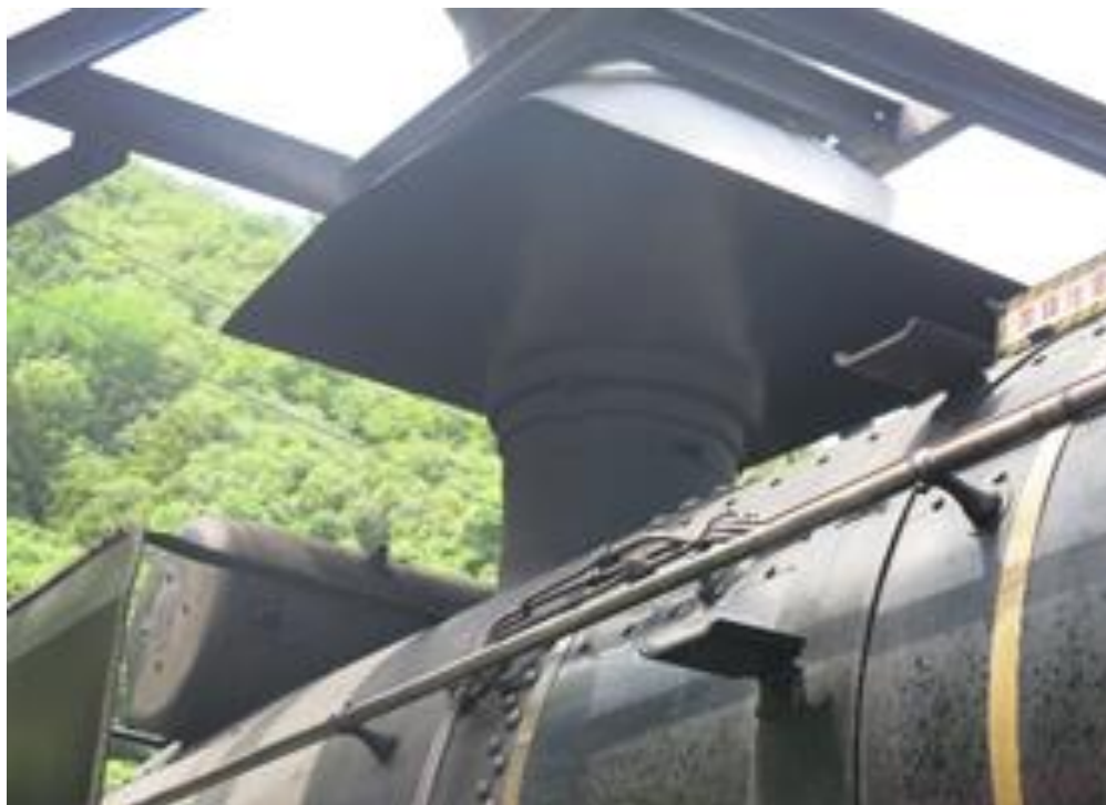
圖70 SL 山口號停於除煙設備處理淨化程序
