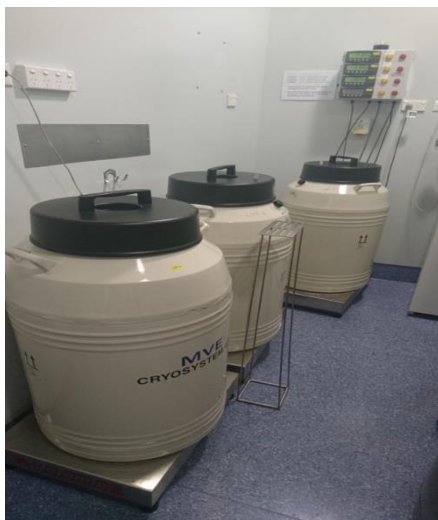
圖 12、種菌保存室即時監測液態氮保存桶氮含量，確保保存環境恆定。
