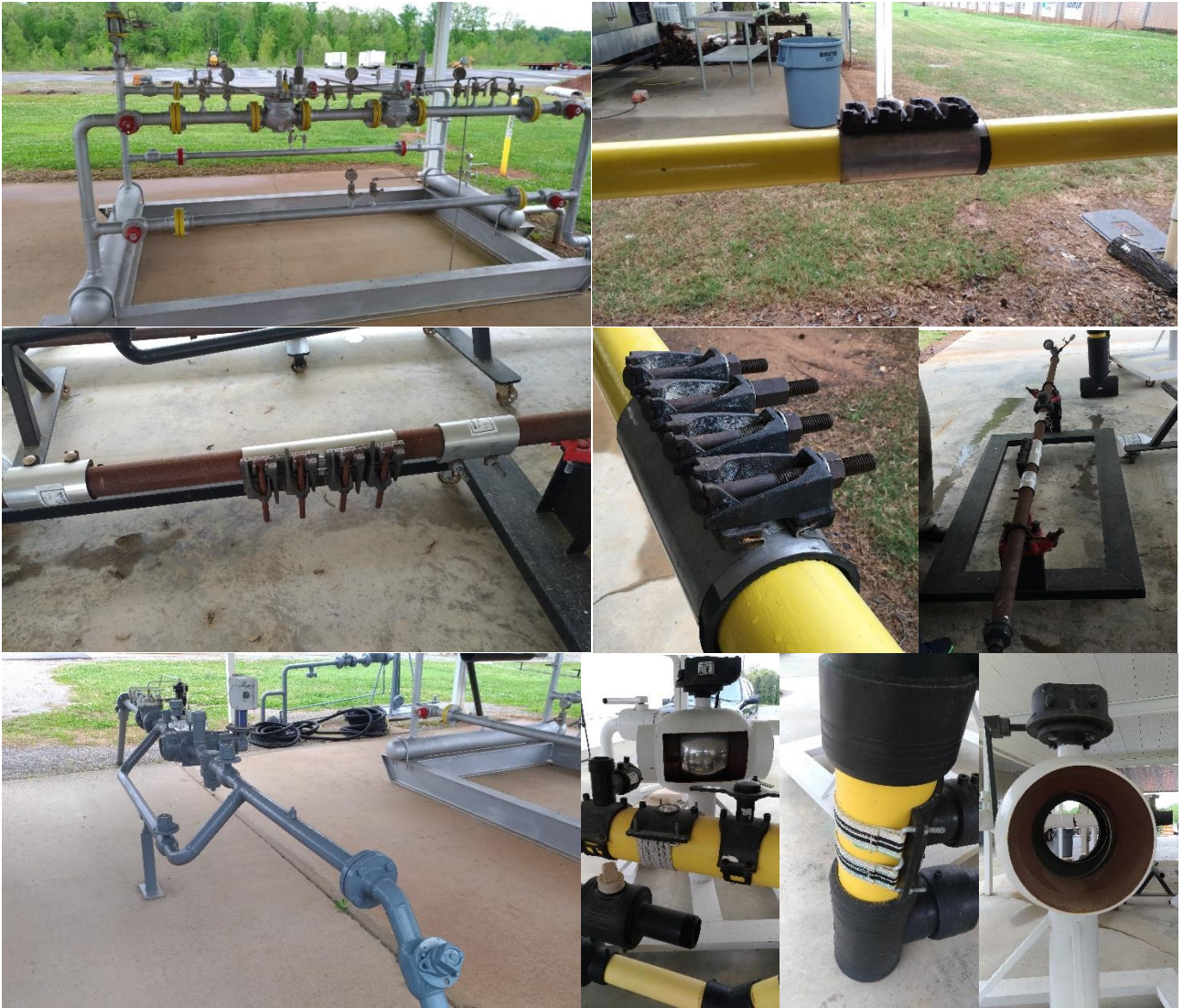
管線及閥件操作/止漏訓練模組
