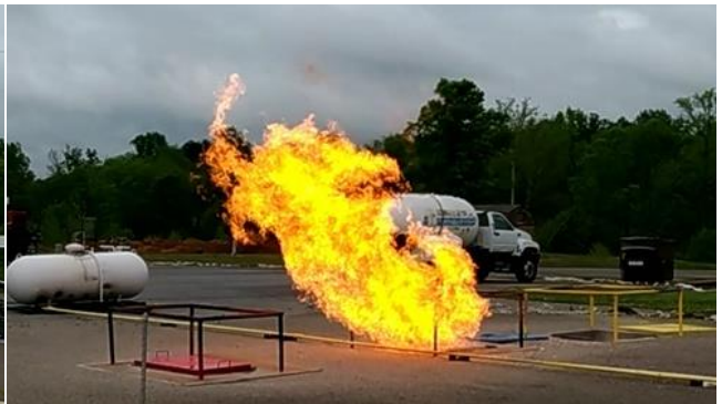
土壤覆蓋地下管線洩漏燃燒之情境
