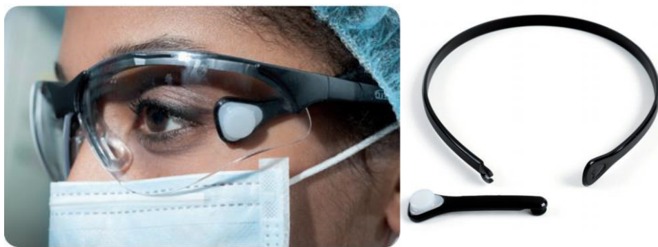
圖 7. 法國廠商 IRSN 所研發之眼球水晶體劑量計
