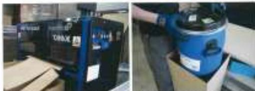
BOD(イタリア PANOTEC社製) BODで作製した商品サイズに合った段ボールケース
