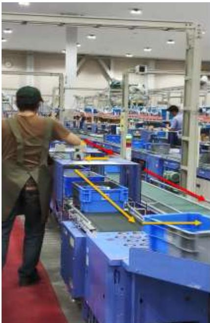
圖 10 A 棟分揀線高頻率主線(紅線)、區域(黃線)流動方式
