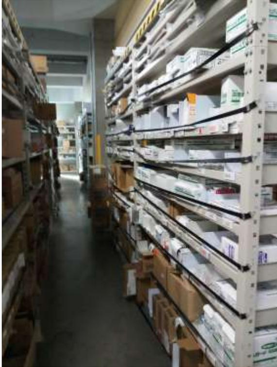
圖 73 TRUSCO 防地震止落線
