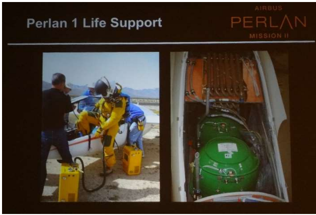
圖 6、液態氧槽設置
