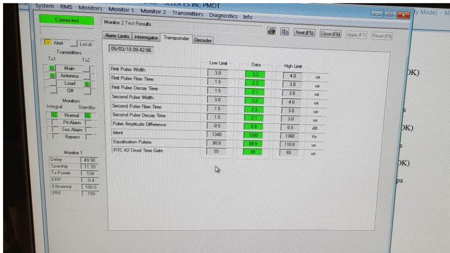
10. **Transponder Decoder Tests** : 檢視MONITORS對TX1及TX2的DECODER之測試是否正常。
