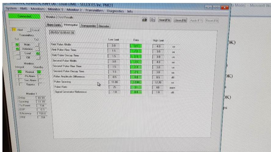
9. **Transponder Signal Test** : 檢視MONITORS對TX1及TX2發射信號之測試是否正
