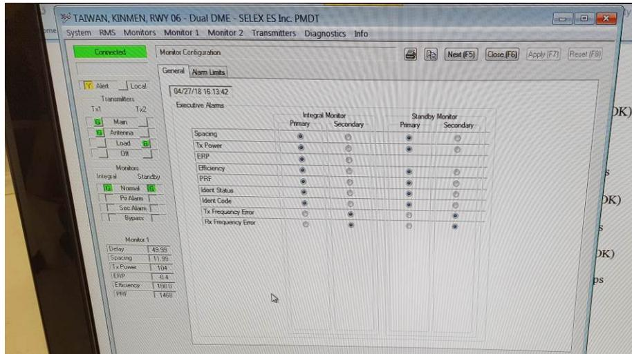
6. **Monitor Alarm Limits Configuration Verification** : 檢視MONITORS告警臨界參數設定是否正確。
