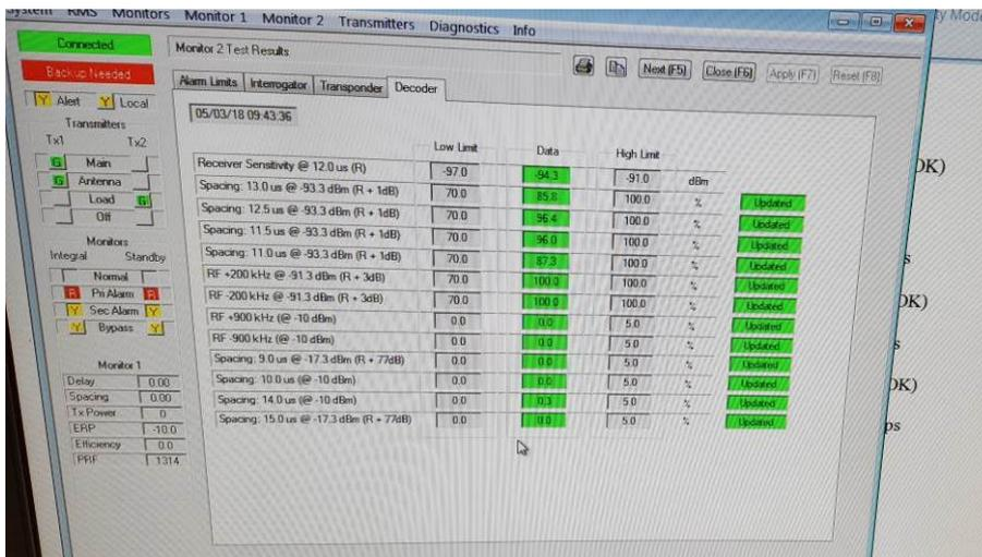
11. **RCSU Controls** : 驗證RCSU之連線功能及軟體連線操作，RCSU面板操作控制及燈號顯示是否正常。
