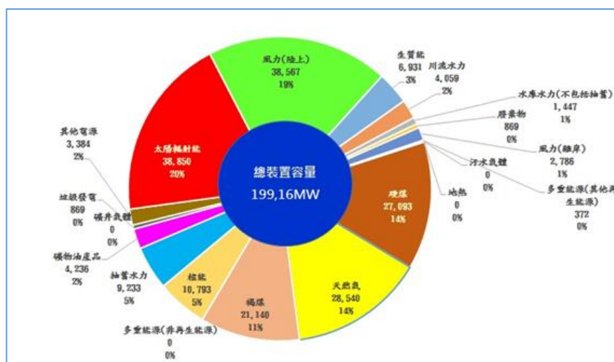
圖6 2015德國再生能源發電裝置容量比例
