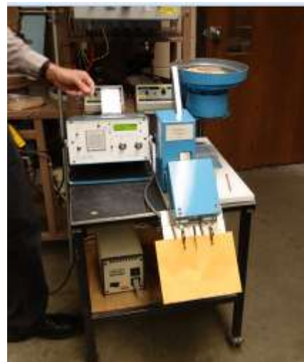
影像識別種子計數器擷取種子影像後可依顏 色進行種子批品質評估
