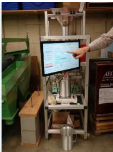
具學習功能的種子計數器，可找出不同種子 最適合的下落速度以精準計數
