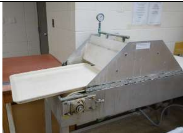
發芽介質加水設備，半自動化加入定量去離子水
