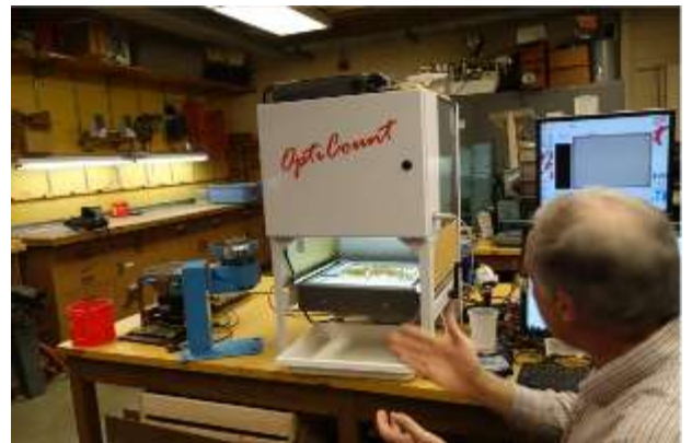
影像識別種子計數器擷取種子影像後可依顏 色進行種子批品質評估
