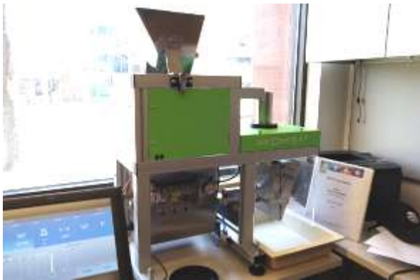
影像感應種子計數器可將同時落下的種子正 確計數
