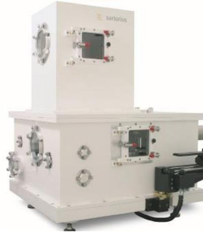
圖 5 真空質量比較儀
