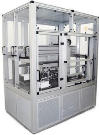
圖 4 機器手臂自動質量比較儀
