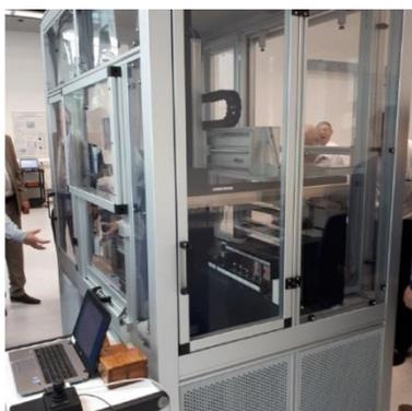
圖 7 機器手臂自動質量比較儀
