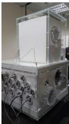
圖 44 真空質量比較儀
