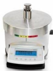
圖 2 磁性檢測儀器
