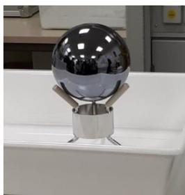
圖 37 矽晶球置於三腳架
