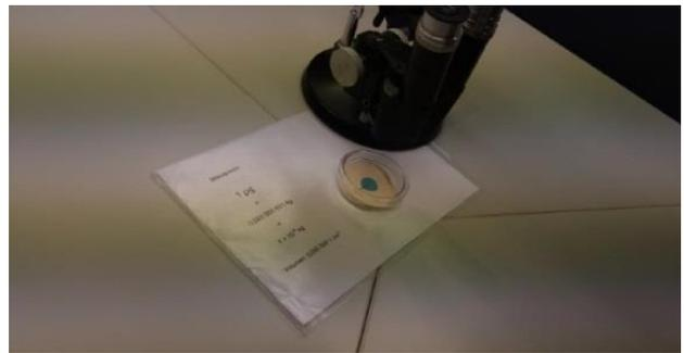
圖 50 1  $\mu\text{g}$  不銹鋼標準法碼
