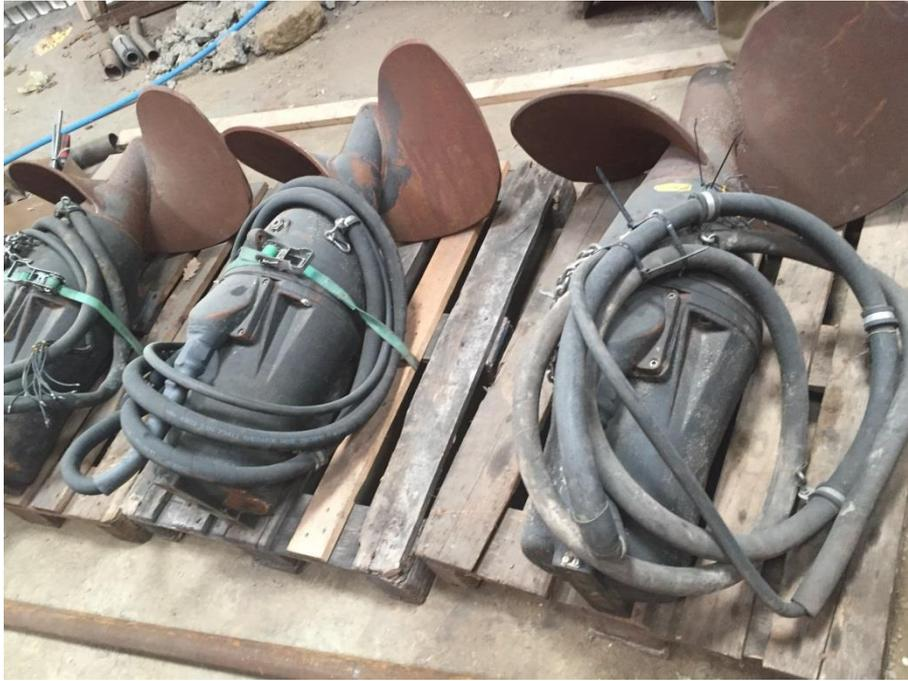
圖 33 水平攪拌器
