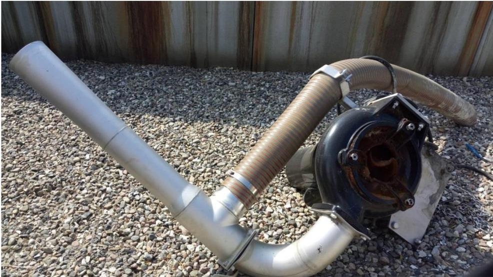
圖 32 損壞之攪拌泵
