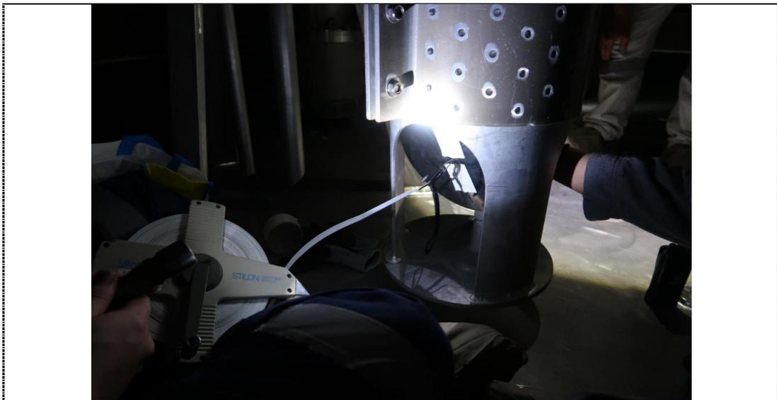
圖 10: 工作人員於槽底進行量測工作。工作人員將捲尺貼於液位計底部後，輕微地上下移動液位計，讀取捲尺數值，並重複量測三次，逐次記錄數據；最後採用三次量測數據之平均值作為量測結果。
