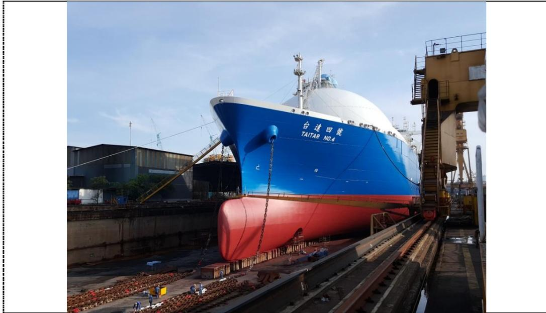
圖 4：台達四號乾塢上架，並已完成船殼油漆補強。船體外板清潔直接影響航行效率，油漆品質要求上須具有防鏽蝕、防海藻攀附之防護功能；油漆共分成上下兩部分(藍上紅下)，具有不同功能及耐蝕程度。另全部錨鍊部亦須檢視其鏽蝕狀況、重新上漆。
