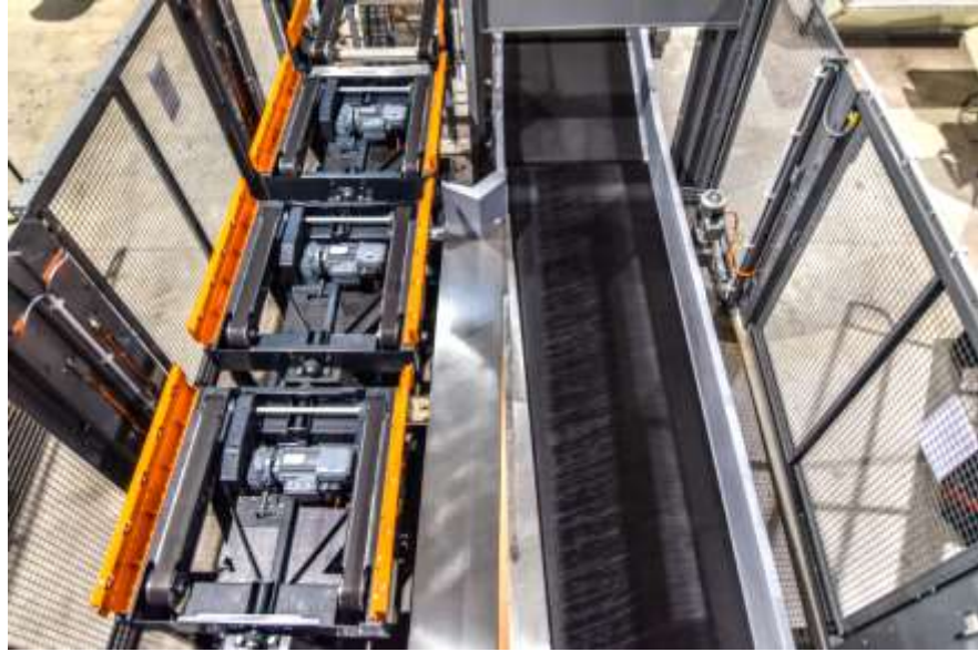
圖 44. 左側為快速小車軌道，右側為皮帶輸送帶
