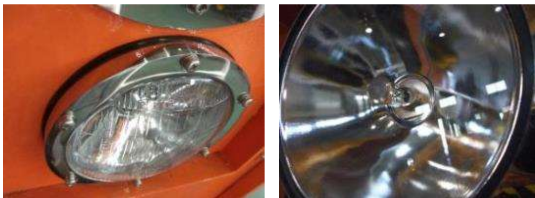
圖 15 LED 頭燈改造照片
