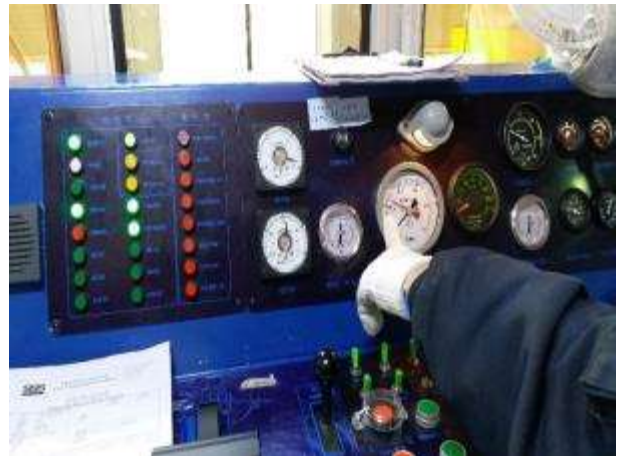
1-2 BC 直接煞車 2.5 \text{ kg/cm}^2 \pm 0.1 \text{ kg/cm}^2
