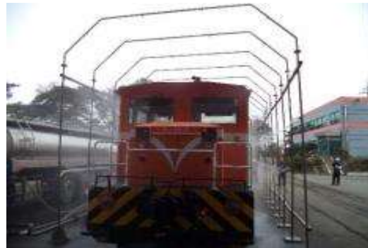
水壓無法達到 2\text{KG}/\text{CM}^2
