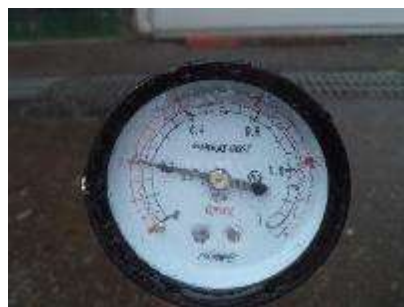
確認水壓達 2kg/cm 2 計時開始
