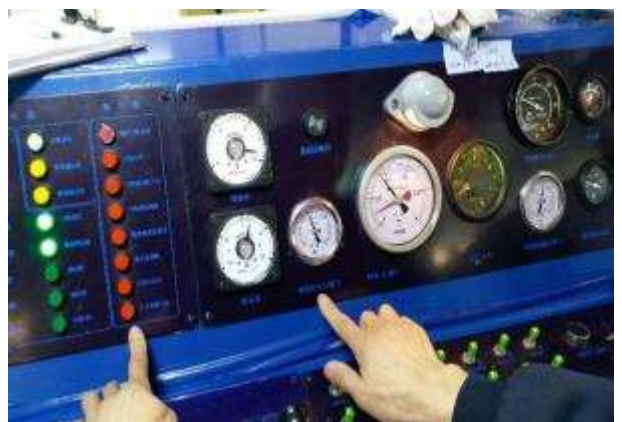
1-3 主風缸壓力 MRPS 高於 6.0 \text{ kg/cm}^2 燈亮滅
