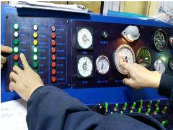
2-5 手動駐車煞車(停留軔機燈亮)
