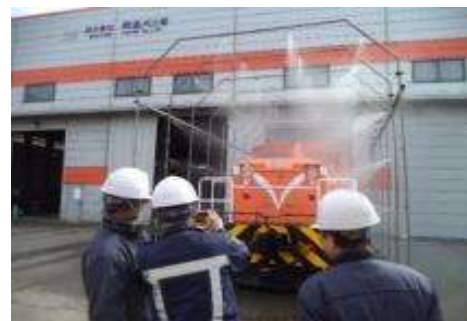
過程中再確認水壓正常
