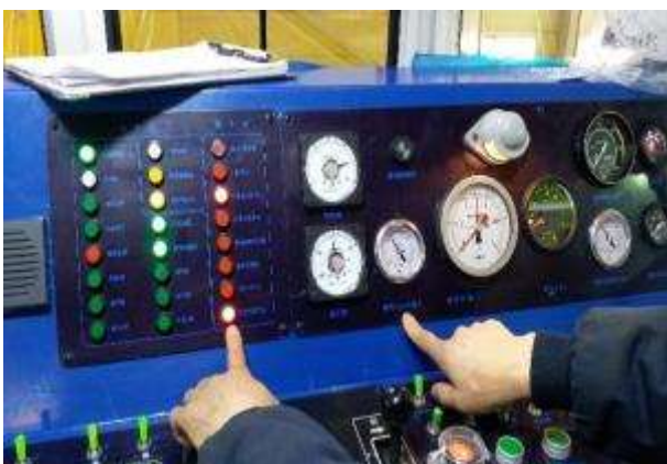
1-3 主風缸壓力 MRPS 低於 6.0 \text{ kg/cm}^2 燈亮警告
