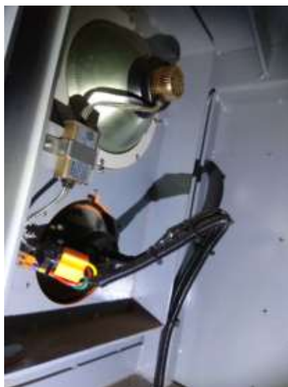
檢查電瓶室內側燈罩框架滲水
