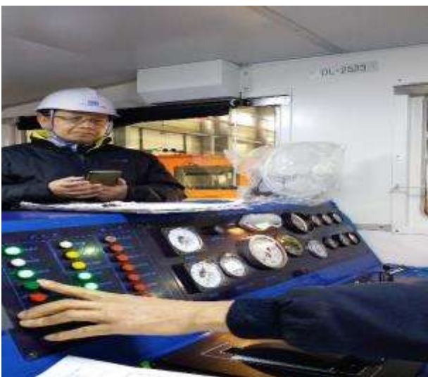
2-5 手動駐車煞車(停留軔機燈亮)
