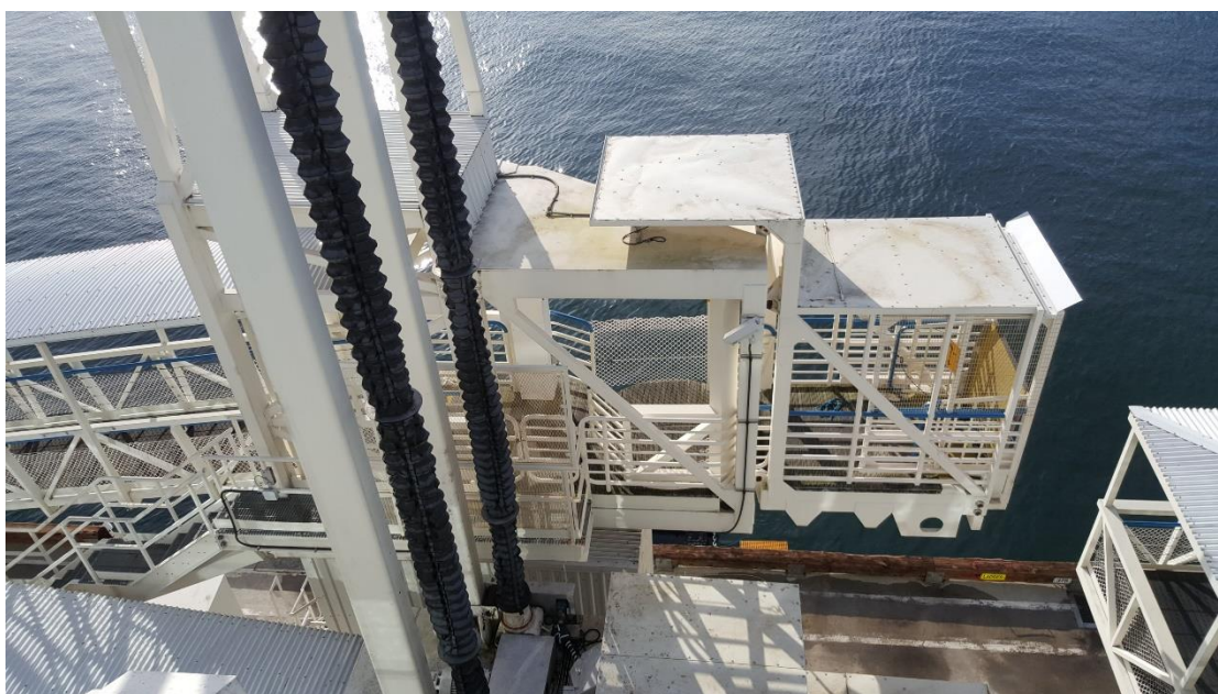
圖 75、旅客橋的搭船側是可旋轉，並有蛇板可伸出
