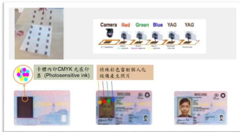
圖 3-72 光感印墨層+特殊雷射蝕刻後個人化之彩色照片解決方案
