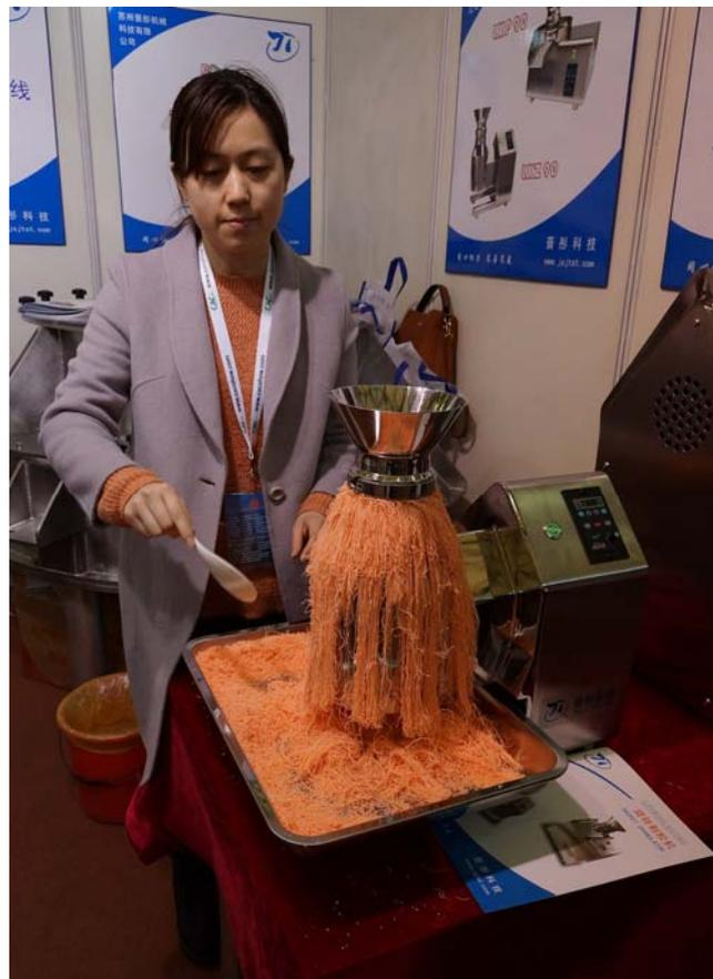
圖十八、實驗室級小量試量產—擠壓造粒設備
