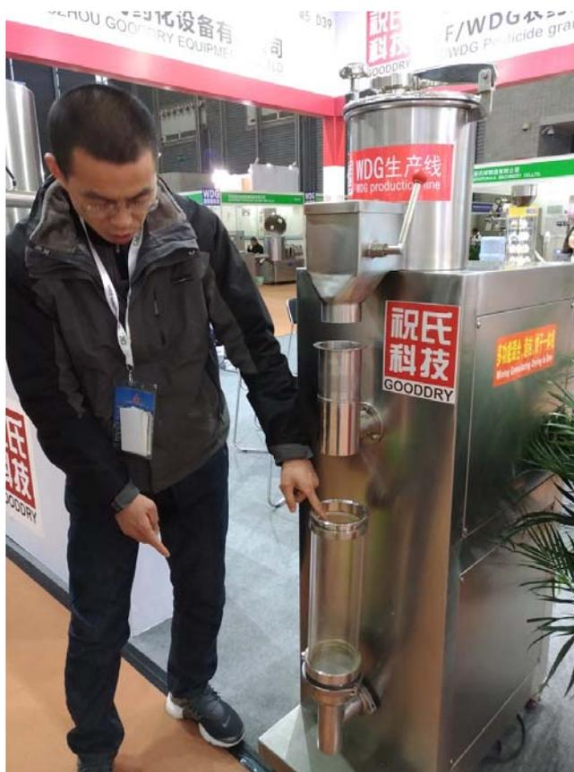
圖十九、實驗室級小量試驗產—水分散粒劑(WDG)智能設備
