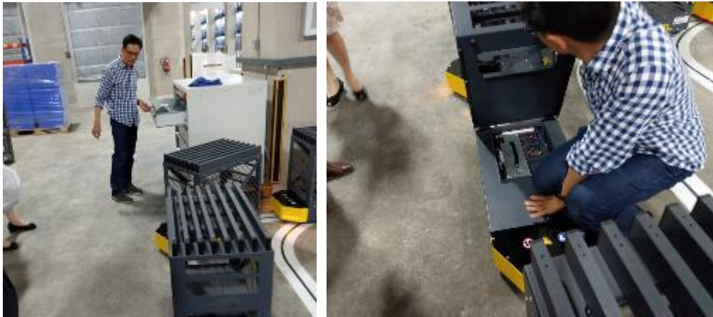
圖 101 自動導向車的充電區與電池更換方式
