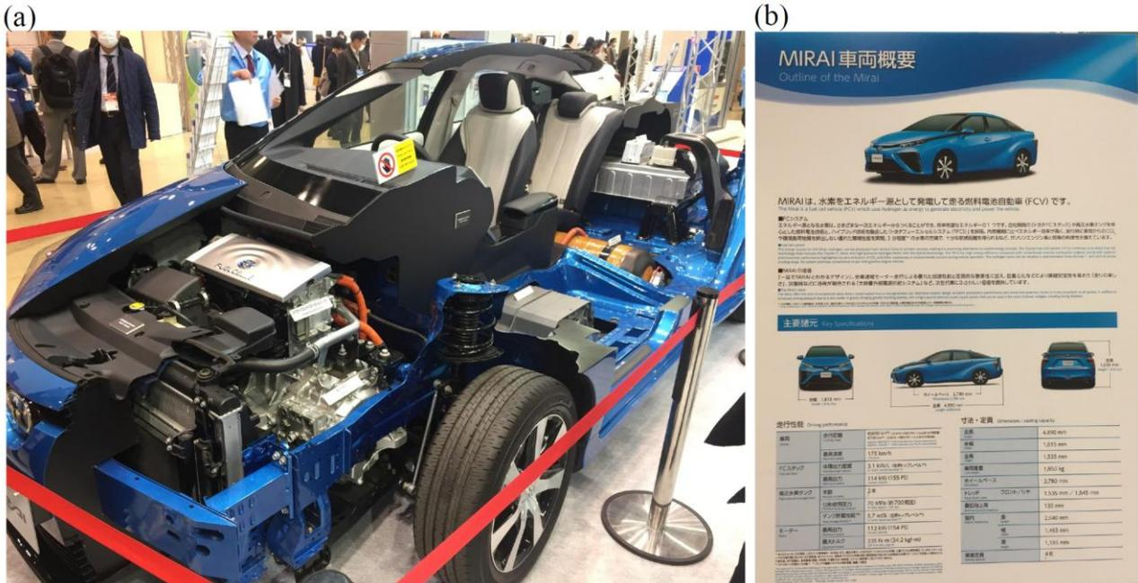
圖 6. Toyota 氫燃料電池車 Mirai:(a)正面結構圖、(b)性能彙整表。
