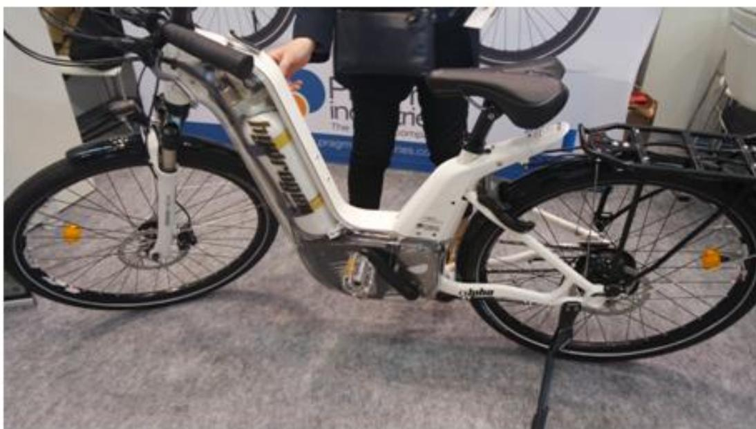
圖 13. (a)燃料電池系統、(b)燃料電池腳踏車
