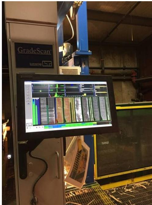
圖 8：每片板材經過掃描機後，立即呈現整片板材各部位的密度影像與數據，做為下一步驟自動分級的依據。
