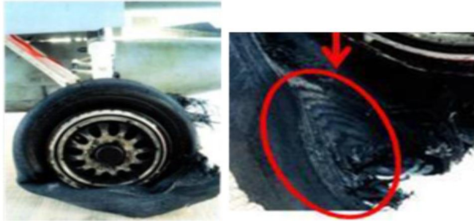
圖五 左起落架爆胎示意圖
