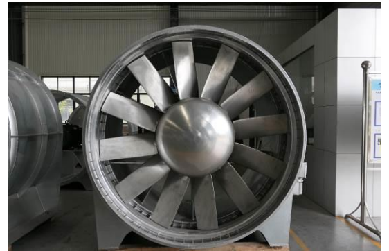
圖 3-4.14 場內擺設之隧道風機
