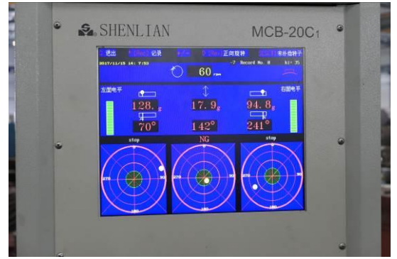
圖 3-4.20 風機葉片運轉平衡檢測儀
