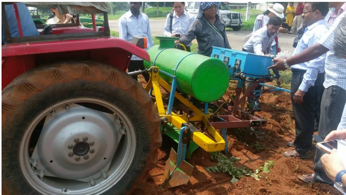
圖二、印度 ICAR 研發之雜糧播種機。綠色圓筒為水箱，藍色方箱為種子桶，利用太陽輪驅動，逐粒播種，並且在播種時同時進行灑水動作，以增加種子存活率。
