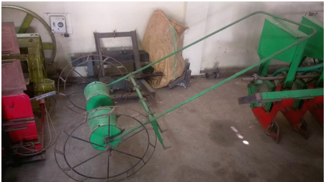
圖三、印度 ICAR 研發之人工播種機。屬於可拆解式，因此方便攜帶，綠色圓筒上方有固定孔洞，當圓筒轉至固定位置時會進行播種作業。
