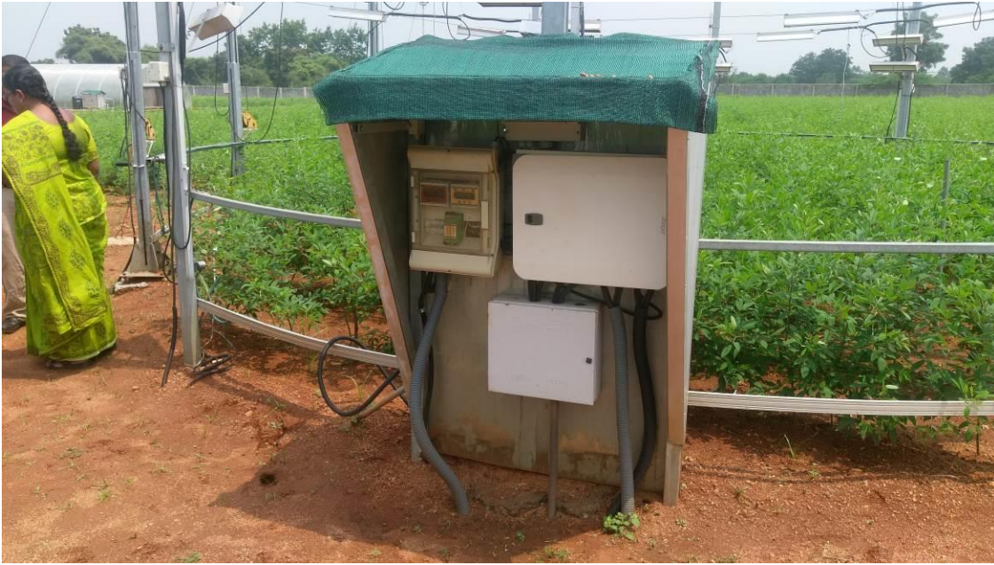
圖五、印度 ICAR 研究逆境分析的田間設備。內含有控制器、感測器、加熱器、噴霧降溫系統...等，用來研究當大氣環境溫度過高時，作物的耐候性。
