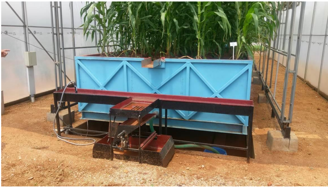
圖七、進流水研究設備，研究土壤進流量設備。
