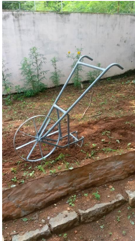
圖四、印度 ICAR 研發之人力除草機。輪子後方掛有一組除草機構，利用往復運動將雜草從土面移除，使用起來相當耗力。
