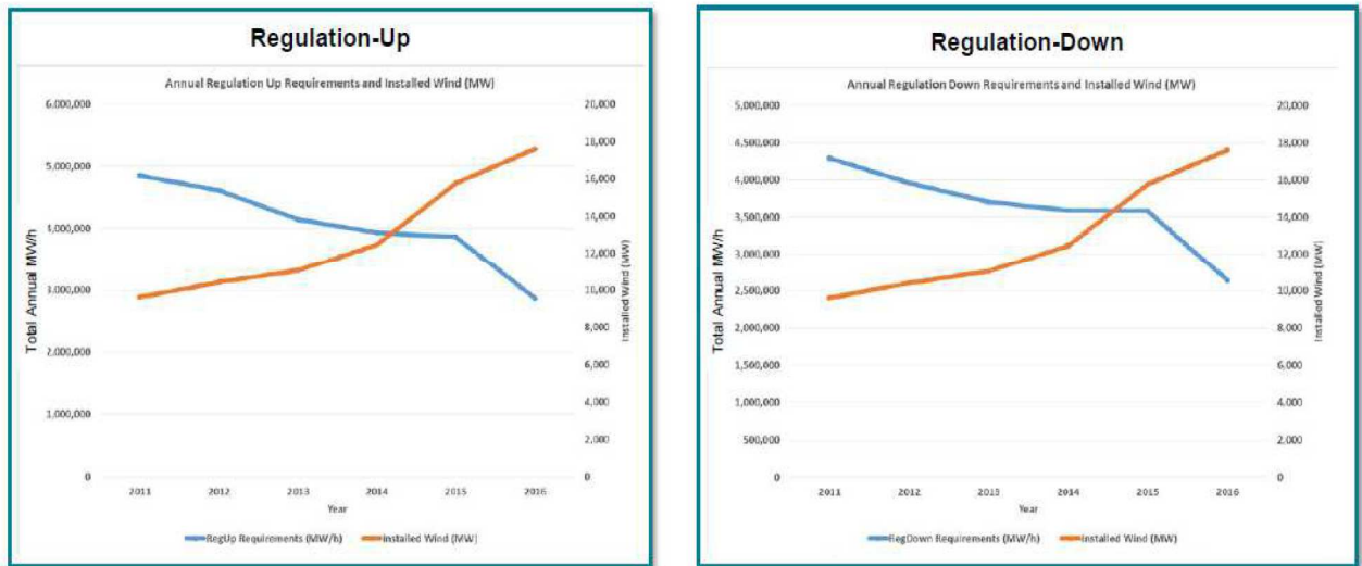
圖 2-18 ERCOT 調頻需求量與風力發電機組裝置容量
