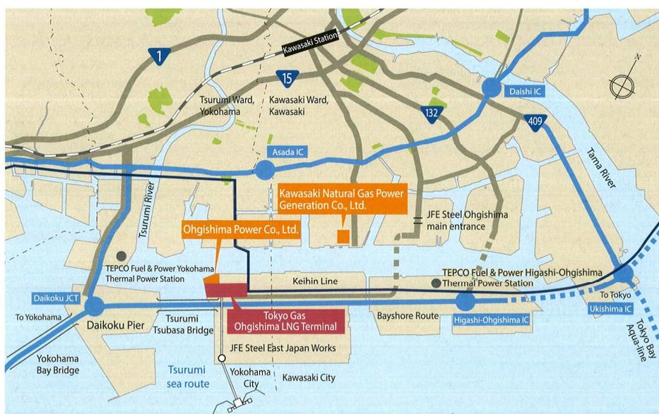
扇島(Ohgishma)天然氣接收站，因為地理位置的緣故，港區面積較小及水深不足，導致 LNG 運輸船無法直接入港，以及入港後，無法完成迴轉出港的動作，又鄰近土地屬於 JFE Steel East Japan Works 所有，所以東京瓦斯公司將碼頭(Jetty)建置在外海離岸，泊船棧橋離岸 500m，採用地下隧道內，配置全銲接天然氣管將天然氣輸送到廠區內。
