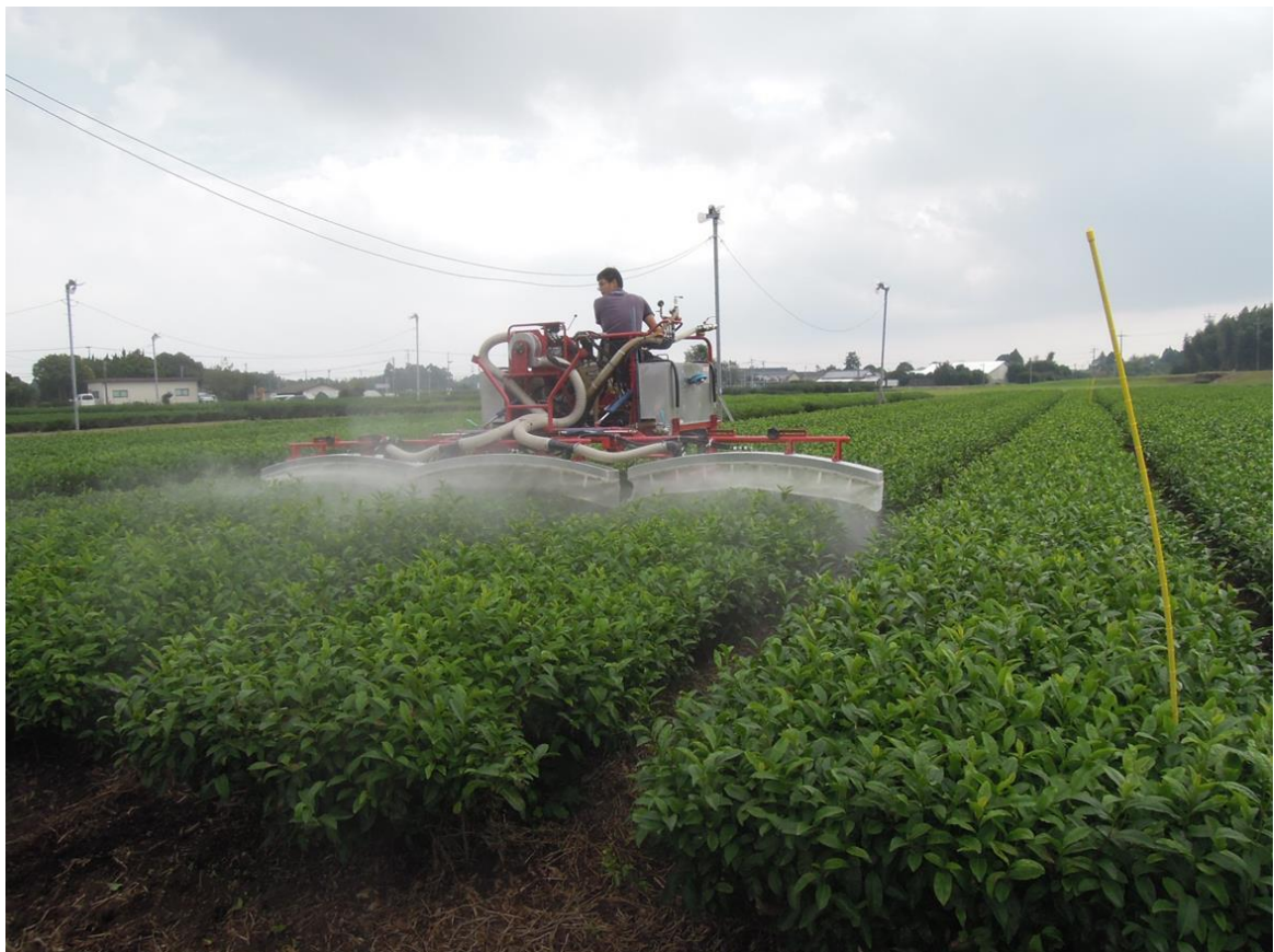
圖十四、少量散布農藥之乘坐式防治機
