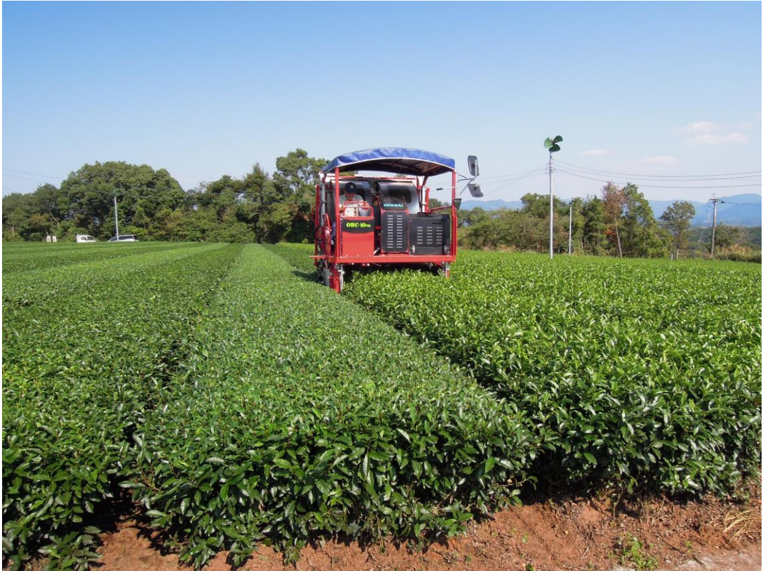
圖一、鹿兒島機械化作業茶園，乘坐式採茶機作業情形
