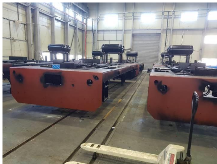
圖2.3.9 調動機車體骨架結構
