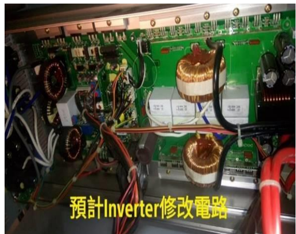
延時繼電器試更改電路至變頻器內部
