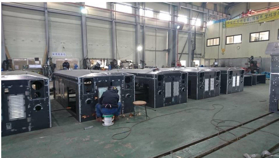
圖2.3.23 引擎室骨架結構
