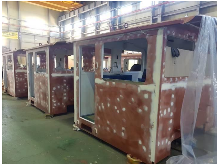
圖2.3.22 駕駛室骨架結構
