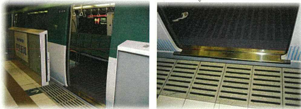
【ホームと車両の段差・隙間を小さくした事例】
