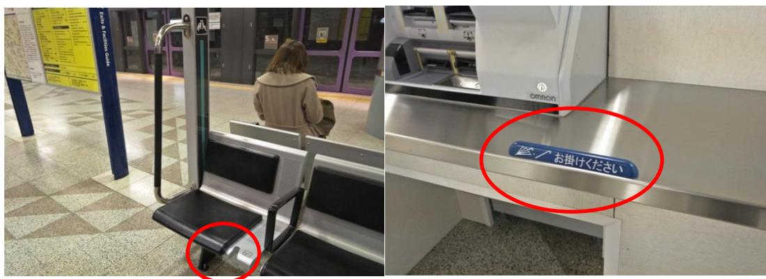
圖 4.1.1 高扶手及拐杖放置槽及購票機平台設置防止拐杖及雨傘之脫落裝置
