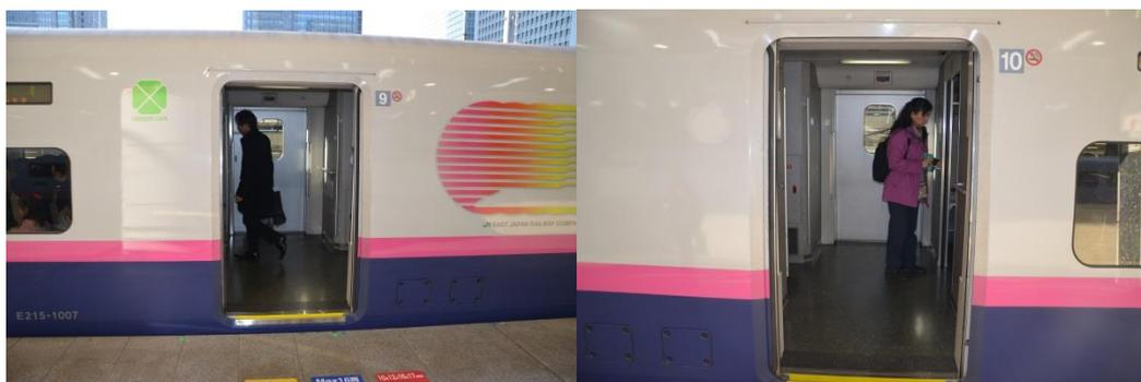
圖 3.4.14 JR 東日本 E2 車型商務車廂(9 號)及指定席車廂(10 號)設計寬敞車門及輪椅通道，使輪椅乘客方便進出
