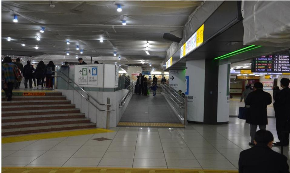
圖 3.4.4 東京車站內高低差設置斜坡供輪椅通行
