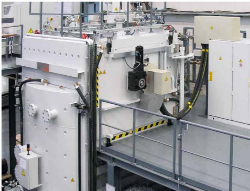
圖 3-2 ALD 公司製造之真空感應熔煉-精密鑄造爐(VIC-IC)。
