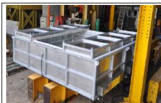
可移動式水平電爐搭配強力地板與反力框架
