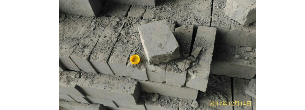
圖 63 燒燼之糠灰混拌水泥製成灰磚
